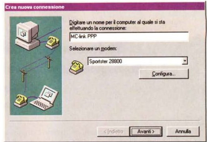
Figura 4 - Nel campo indicato dalla didascalia «Digitare un nome per il computer ecc.» scriviamo, con uno spericolato volo di fantasia, «MC-link PPP». Nel campo indicato dalla didascalia «Selezionare un modem», invece, dovrebbe essere già presente il modello del modem che utilizziamo, se questo è stato correttamente impostato attraverso il Pannello di Controllo.
